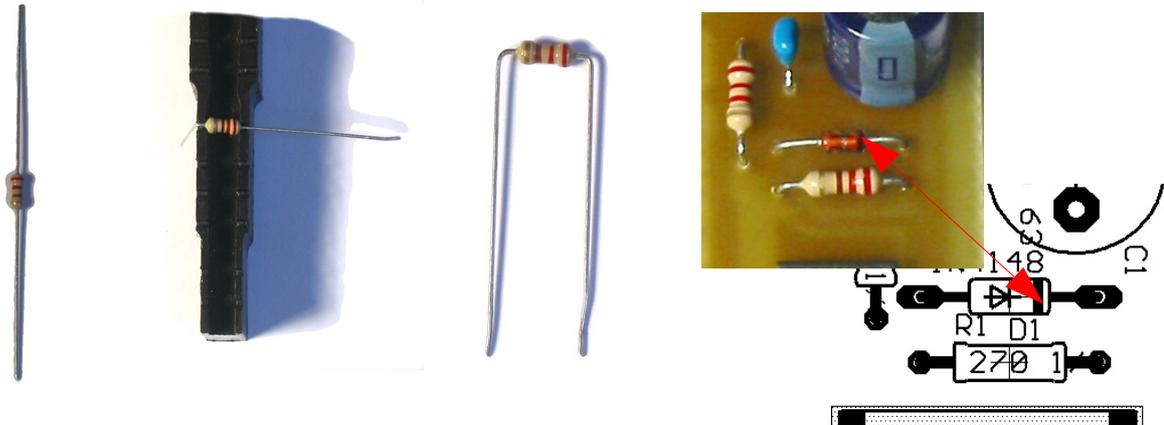
Rohwiderstand (gerade und glatt sollte er zum fe, 10mm gerade ziehen, da dadurch die elektrischen Eigenschaften verändert werden)
