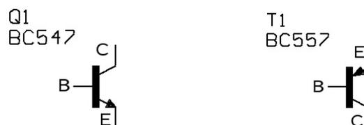
Abbildung 38 NPN Transistor    Abbildung 39 PNP Transistor
