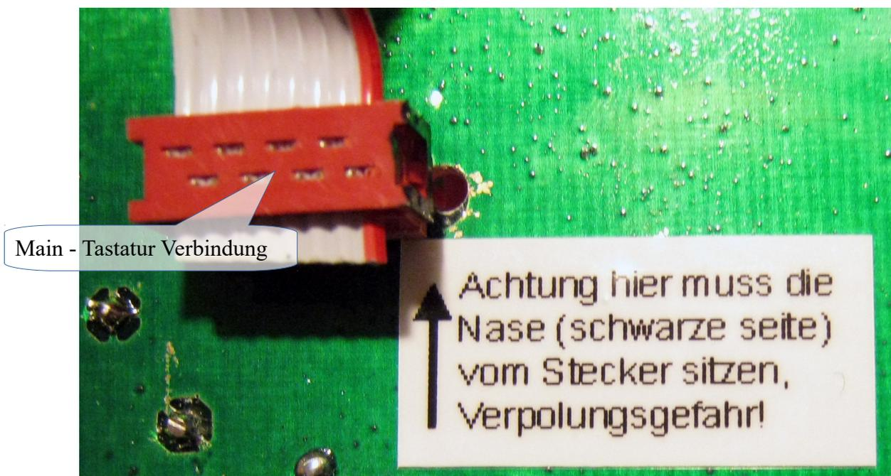
Abbildung 2: Flachbandkabel vom Countdown Timer, KG und den Tastatur Modulen
