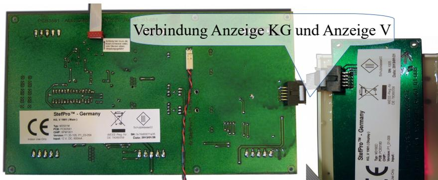
Die Anzeige V wird über ein Flachbandkabel an dem Pfostenstecker sind an die Anzeige KG angeschlossen. Die Spannungsversorgung geschieht über einen 2 poligen Stecker mit einer DC-Buchse am Ende. An der roten Leitung muss +12 Volt (DC) Gleichspannung und schwarz muss 0 V ( Masse) angeschlossen werden. Die Spannungseingänge sind bedingt überspannungsfest und können nicht verpolt werden ( Schutzdiode in reihe).
